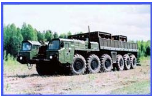
Спецшасси МАЗ-547Э с газотурбинным двигателем и электротрансмиссией. Построен в одном экземпляре в 1980 г.
