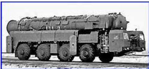
Восьмиосное шасси МАЗ-7906 (16х16) грузоподъемностью 150 тонн для автономной пусковой установки 15У157 ПГРК 15П162 «Целина-2». 1984 г.
