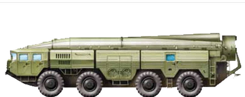
Пусковая установка оперативно-тактического ракетного комплекса 9К76 «Темп-С» (по классификации НАТО SS-12B «Scaleboard») на шасси МАЗ-543, 1965 г.
