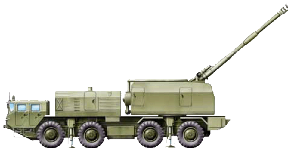
Самоходная 130-мм артиллерийская установка комплекса «Берег» на шасси МАЗ-543М.
