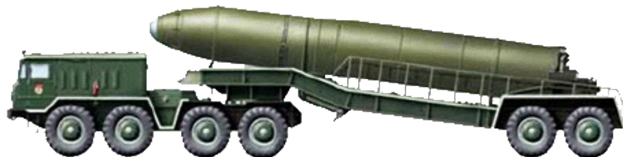
Седельный тягач МАЗ-537Г с полуприцепом, на котором размещена морская ракета Р-29 комплекса Д-9.
