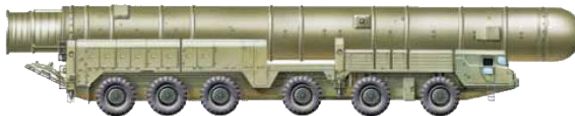
Транспортно-перегрузочный агрегат ракетного комплекса «Пионер» на шасси МАЗ-547А.
