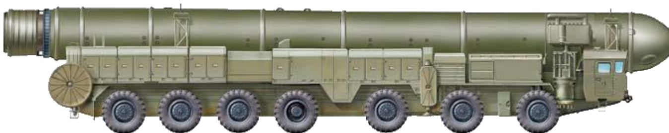
Автономная пусковая установка 15У186 на шасси МАЗ-7917 (14х12) ракетного комплекса 15П658 «Тополь», 1985 г.
