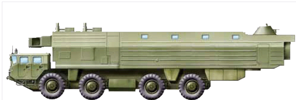
Машина обеспечения боевого дежурства комплексов «Пионер», «Тополь», «Берег» на шасси МАЗ-543М.
