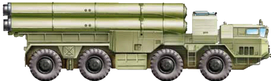
Пусковая установка мобильного комплекса РК-55 со стратегическими крылатыми ракетами «Гранат» разрабатывалась на шасси MAZ-543M и MAZ-79111.
