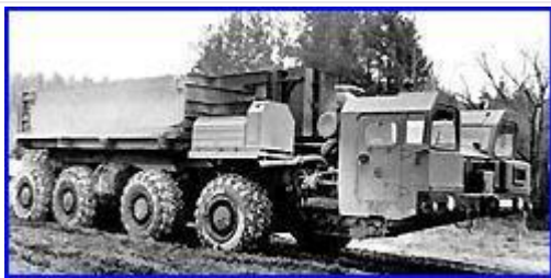
Специальное колесное шасси МАЗ-7929 (10 х 8) для ПГРК с малогабаритной межконтинентальной ракетой «Курьер». 1989 г.
