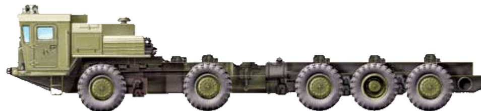
Специальное колесное шасси МАЗ-7909 (8 х 8) для ПГРК с малогабаритной межконтинентальной ракетой «Курьер». 1987 г.
