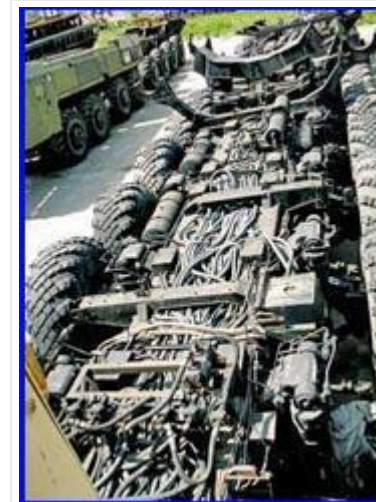
Элементы электротрансмиссии 24-колесного шасси МА3-7907. 2007 г.
