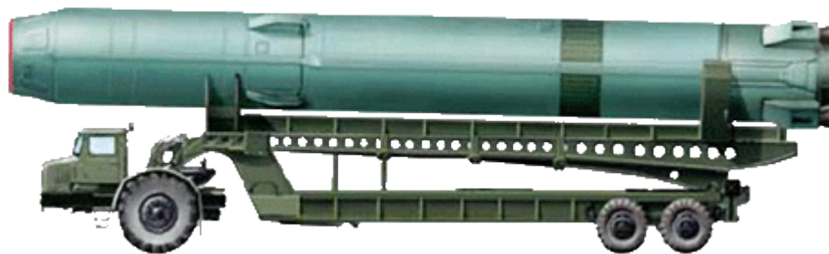
Установщик ракет Р-16 на базе одноосного тягача МоАЗ-546П (модификация МАЗ-529В).
