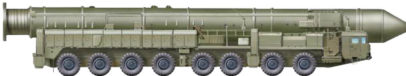
Автономная пусковая установка ПГРК «Тополь-М» на шасси МЗКТ-79221 (16х16), вид справа
