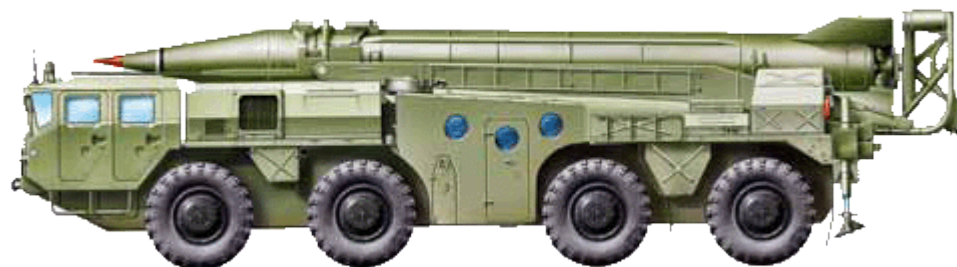
Пусковая установка оперативно-тактического ракетного комплекса 9К72 «Эльбрус» (по классификации НАТО SS-1c Scud B) на шасси МАЗ-543.
