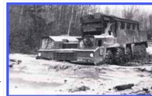
Специальное колесное шасси МАЗ-547А для СПУ ракетного комплекса «Темп-2С» и ТПА ракетного комплекса «Пионер». Выпускалось с 1970 по 1985 годы. (две фотографии).
