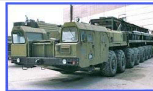
Опытное шасси МАЗ-7922 (16х16) с дизельным двигателем. Изготовлено в одном экземпляре в 1990 г.
