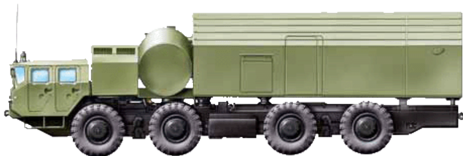
Машина обеспечения боевого дежурства (энергоблок) мобильного грунтового ракетного комплекса РВЧН «Пионер».
