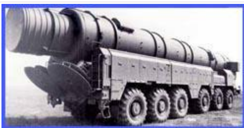
Самоходная пусковая установка 15У136 ракетного комплекса 15П643 «Пионер-2» (УТТХ) на шасси МАЗ-547В
