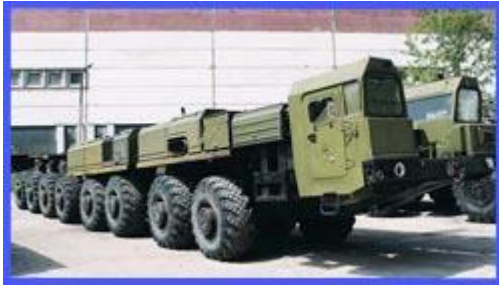
Опытное шасси МАЗ-7923 (16х16) с газотурбинным двигателем и электротрансмиссией. Изготовлено в одном экземпляре в 1991 г.
