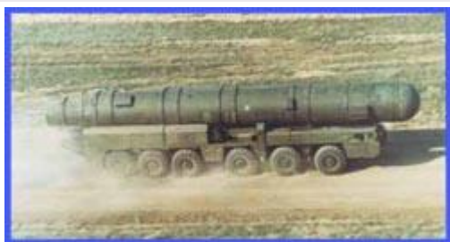
Транспортно-перегрузочный агрегат ракетного комплекса «Пионер» на шасси МАЗ-547А.
