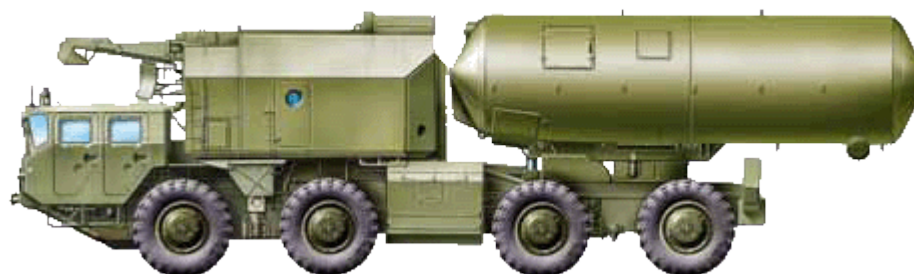
Пусковая установка ЗП51 берегового противокорабельного комплекса 4К51 «Рубеж» на шасси МАЗ-543М.
