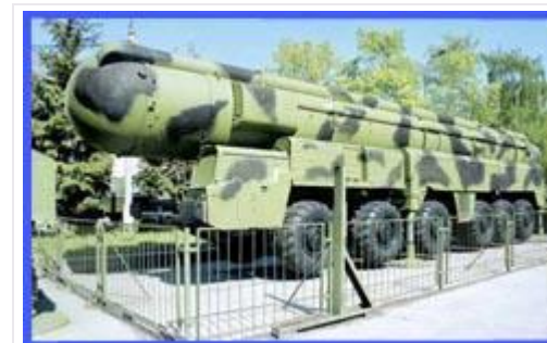
Самоходная пусковая установка 15У136 ракетного комплекса 15П643 «Пионер-2» (УТТХ) на шасси МАЗ-547В. Центральный музей ВС РФ.
