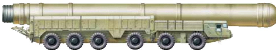
Самоходная пусковая установка ракетного комплекса 15П642 «Темп-2С» с межконтинентальной ракетой 15Ж42 на шасси МАЗ-547А, 1972 г.
