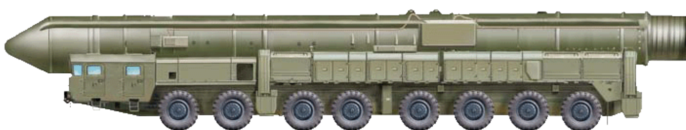
Автономная пусковая установка ПГРК «Тополь-М» на шасси МЗКТ-79221 (16х16), вид справа
