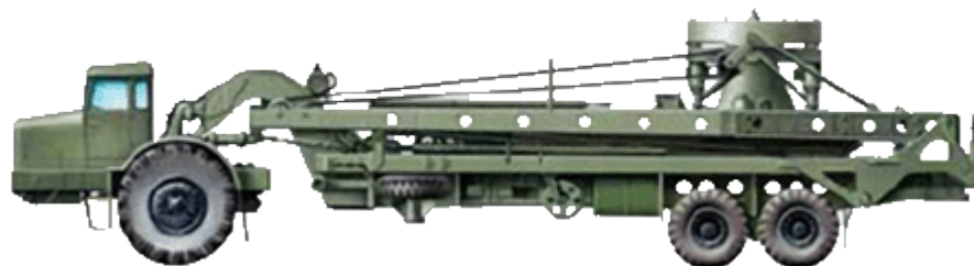
Установщик 8У210 для ракет Р-12 на базе одноосного тягача МАЗ-529В.
