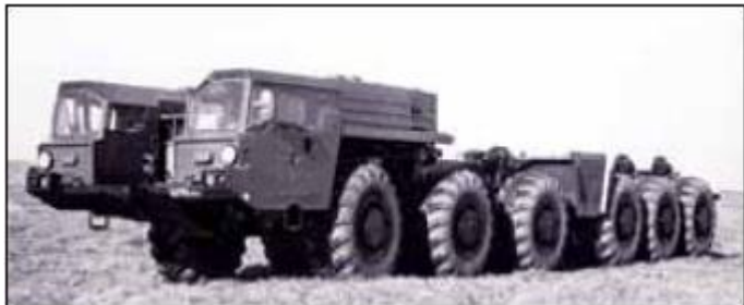
Специальное колесное шасси МАЗ-547А для СПУ ракетного комплекса «Темп-2С» и ТПА ракетного комплекса «Пионер». Выпускалось с 1970 по 1985 годы. (две фотографии).
