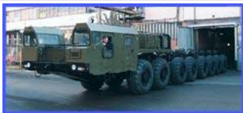
Первое серийное спецшасси МЗКТ-79221 (16х16) для АПУ «Тополь-М». 1995 г.
