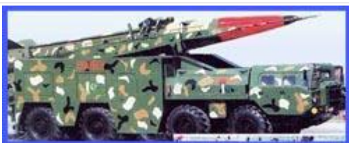
В Пакистане на шасси МАЗ-543 разместили пусковую установку твердотопливной ракеты Хатф 4 (Шахин).
